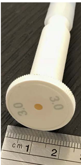
Рис. 2.4, Соединительная деталь ABS-DF с калибровочным элементом типа AF
