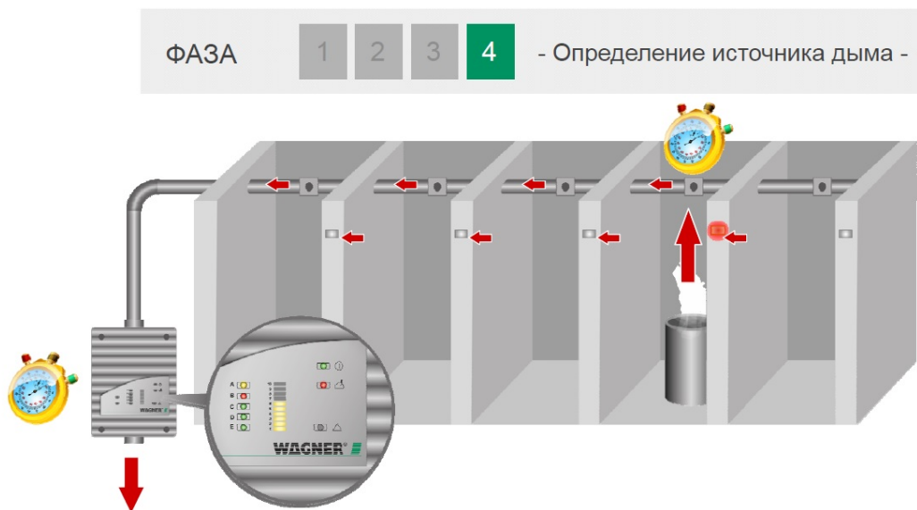
Рис. 4, Возвращение в нормальный режим и передача адресного сигнала «Пожар»
