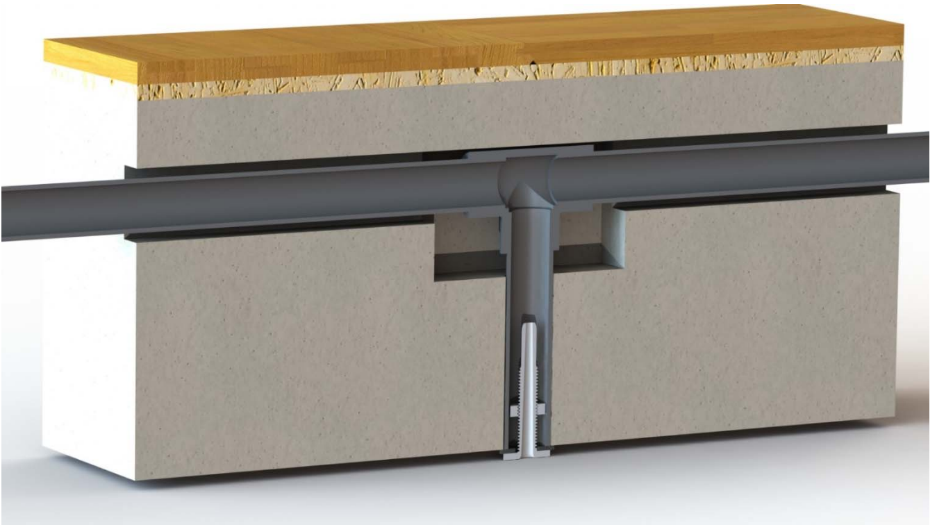
Рис. 4.2.1, Схема размещения аспирационных труб в конструкции здания
