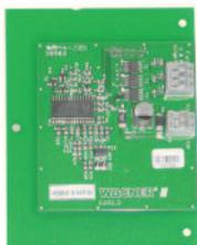
Управление вентилятором аспирационного извещателя
