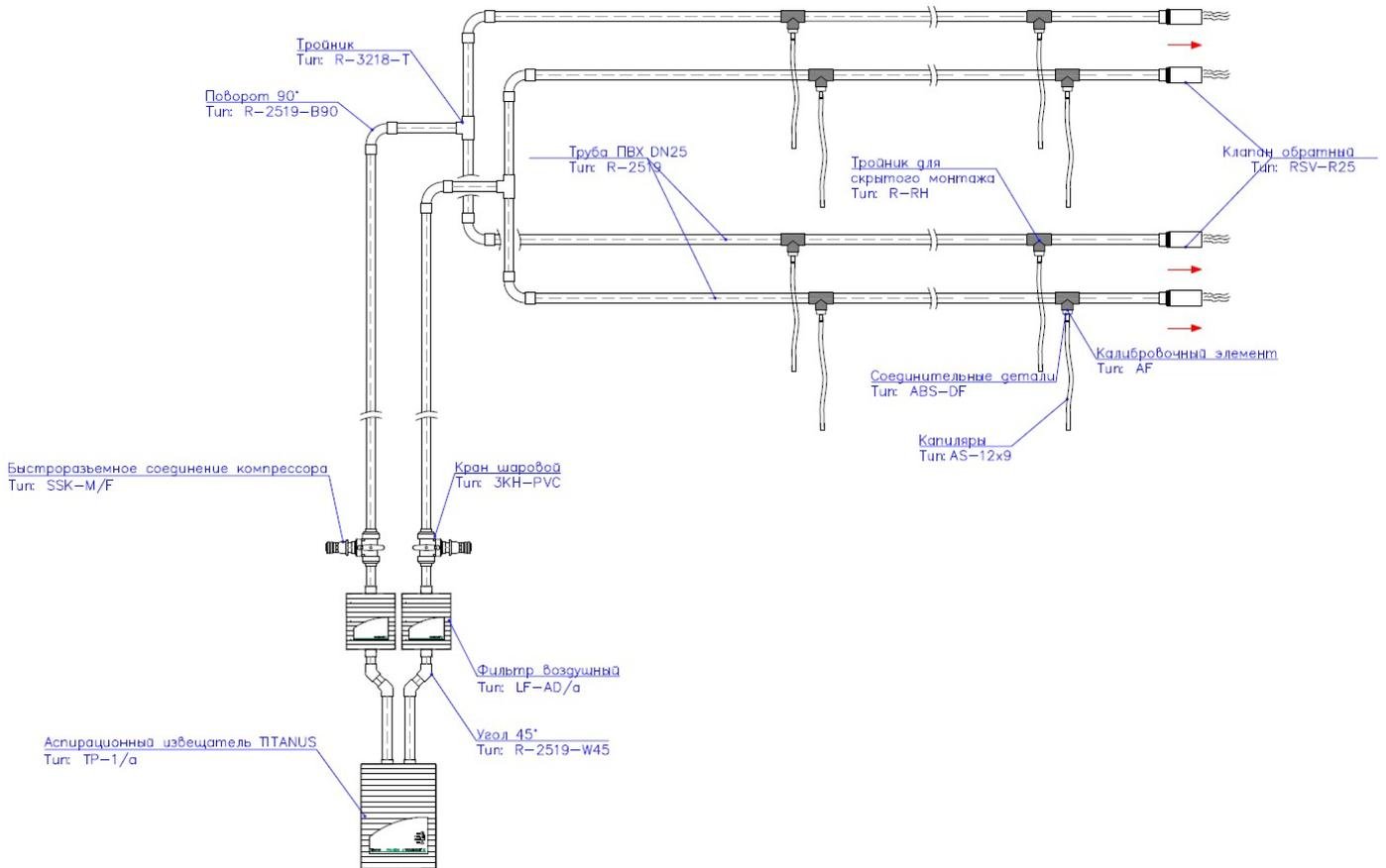
Рис. 2.5, Элементы системы при схеме организации скрытого монтажа с использованием тройника для скрытого монтажа R-RH
