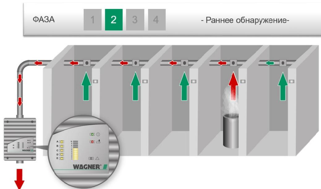
Рис. 2, Обнаружение возгорания и передача сигнала «Пожар»
