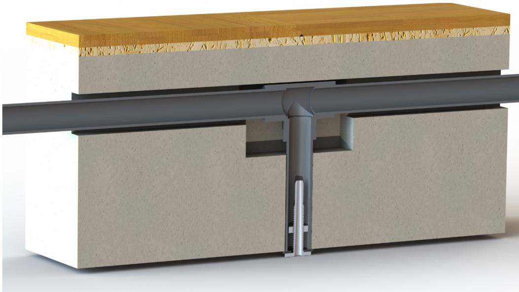
Рис. 2.7, Монтаж аспирационной трубы внутри бетонных конструкций здания
