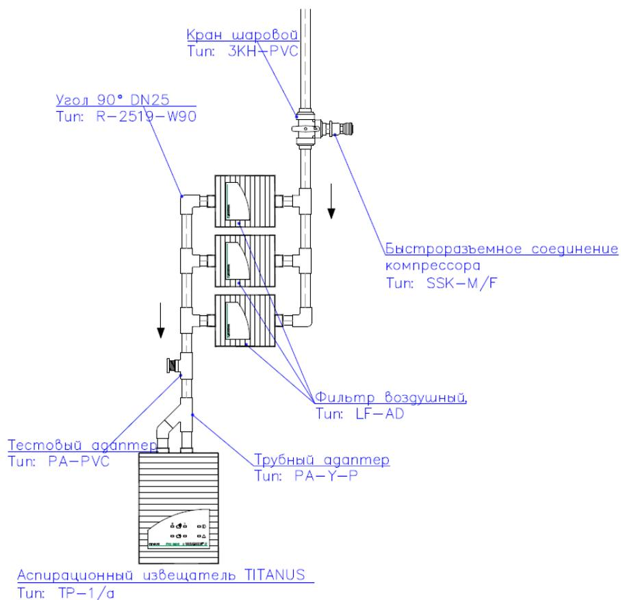
Рис. 1.1.2.1, Пример реализации концепции «мульти-фильтр», фильтры с одинаковой пропускной способностью
