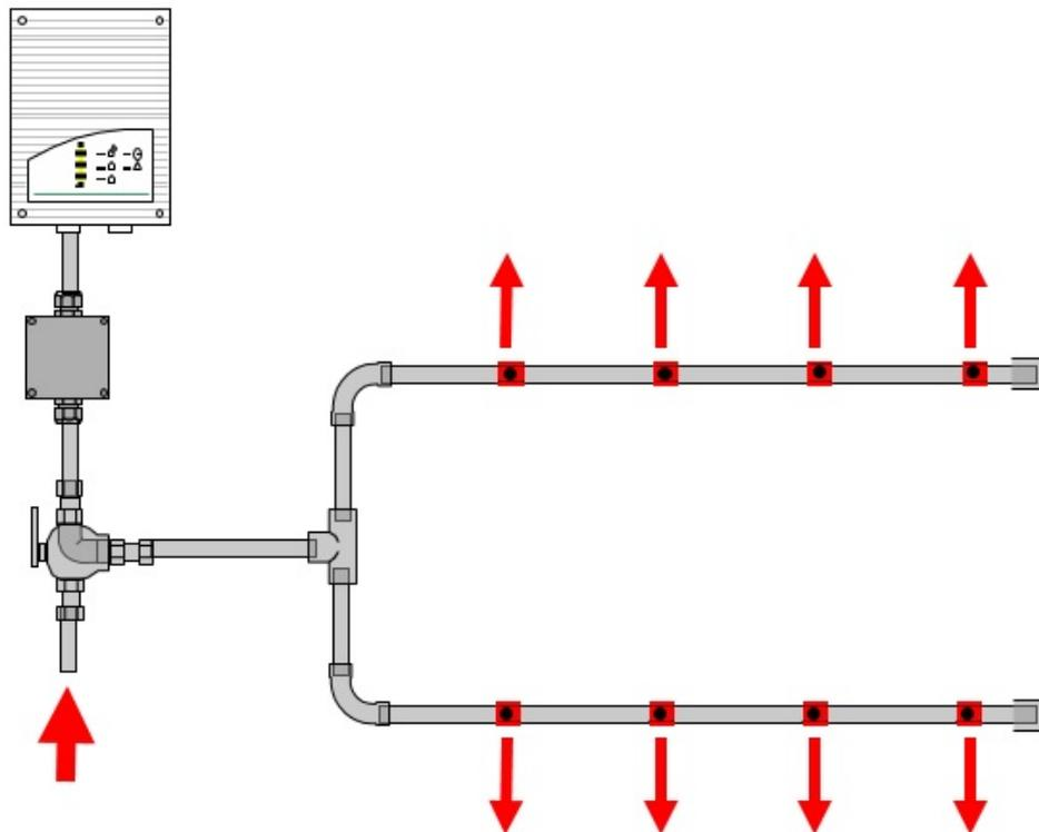
Рис. 1.3.1, Процесс продувки аспирационных труб сжатым воздухом в низкотемпературных зонах. Удаление наледи с воздухозаборных отверстий
