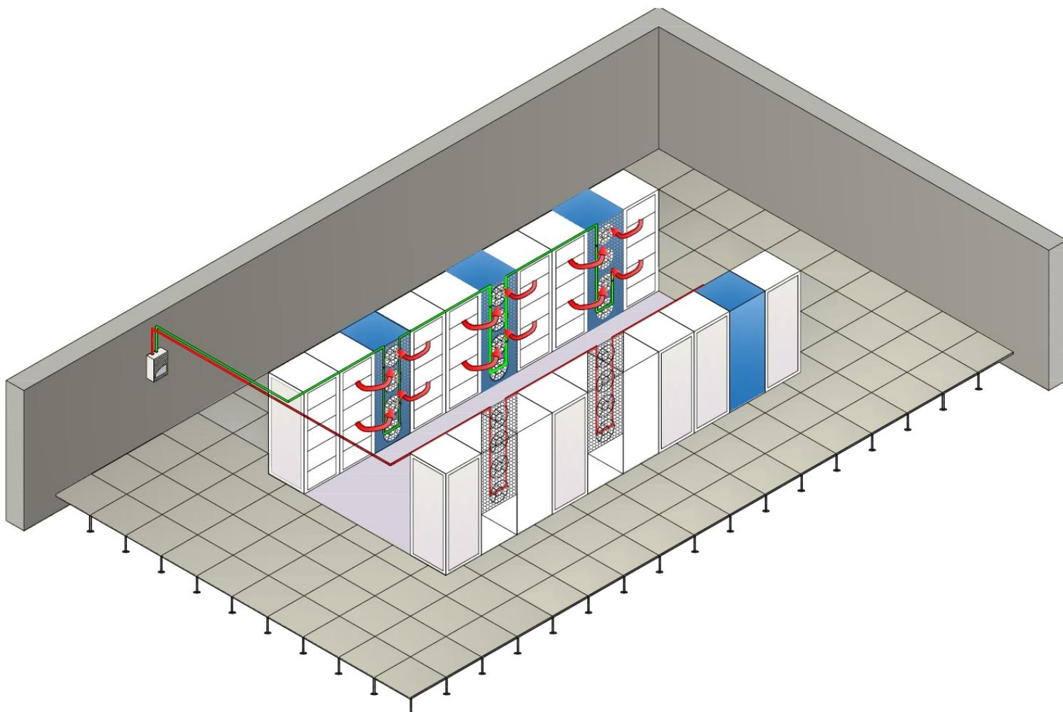
Рис. 3.3, Пример расположения аспирационных труб и отверстий на входе «горячего воздуха» в межрядные кондиционеры
