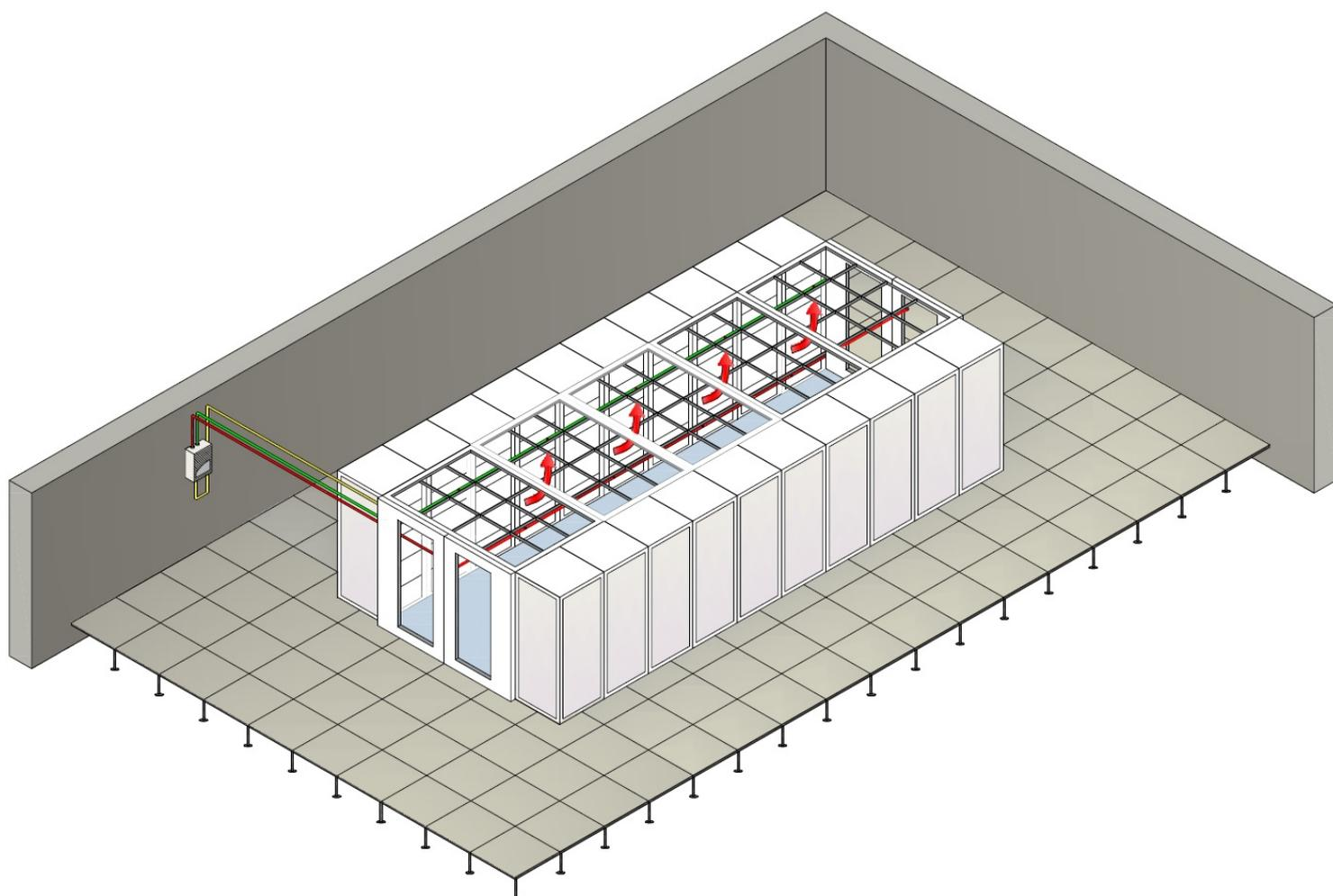
Рис. 3.4, Пример расположения аспирационных труб и отверстий внутри изолированного «горячего коридора»; дополнительная труба обеспечивает возврат воздуха от извещателя внутрь «горячего коридора»
