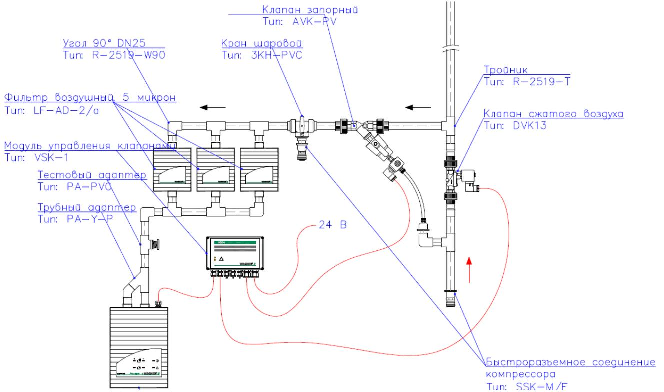
Рис. 1.1.1.1, Пример состава оборудования системы автоматической продувки аспирационных труб сжатым воздухом
