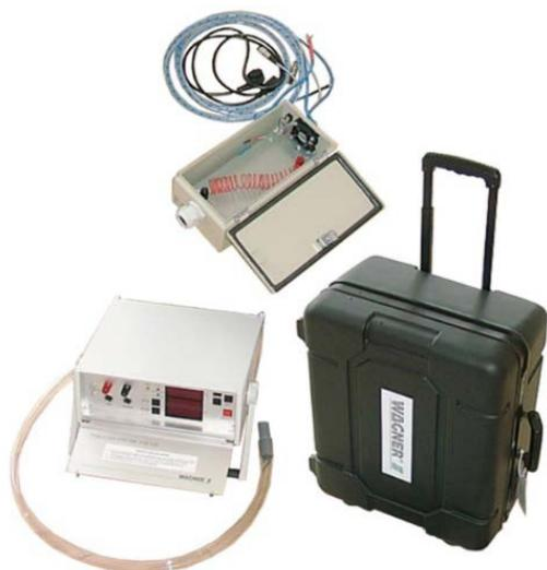
Рис. 3.10, Состав оборудования пиролиз-тестера PYS-100
