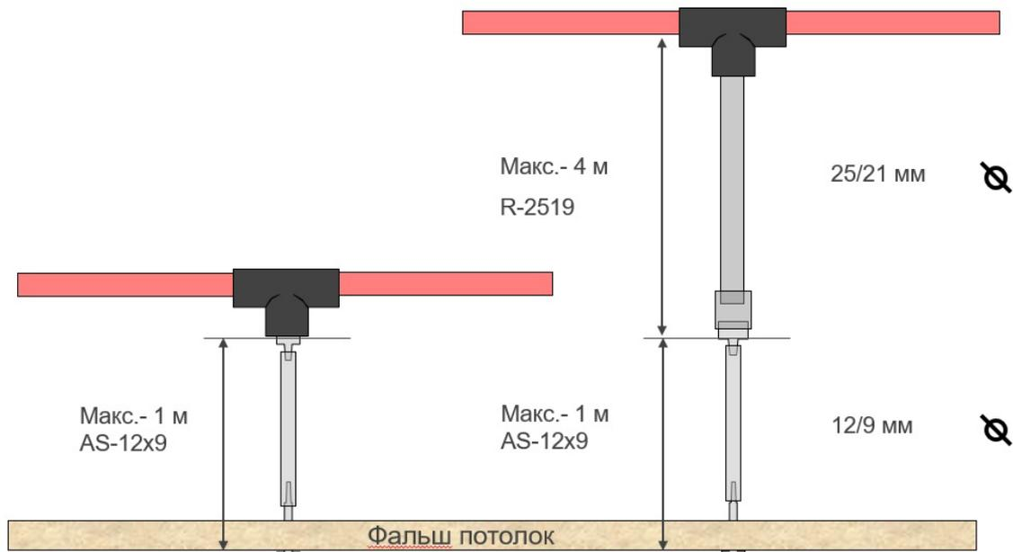
Рис. 2.2, Варианты построения ответвлений воздухозаборной трубы
