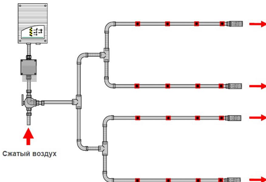
Рис. 1.1.1, Ручная продувка аспирационных труб сжатым воздухом
