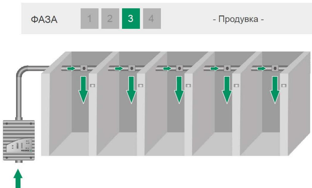
Рис. 3, Включение обратного вентилятора и продувка камеры анализа
