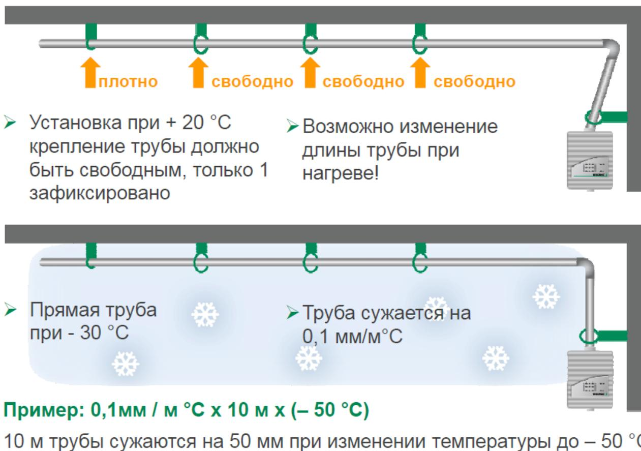
Рис. 1.3.2, Крепление трубы в низкотемпературных зона
