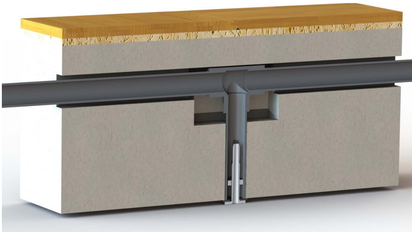
Рис. 4.2.1, Схема размещения аспирационных труб в конструкции здания
